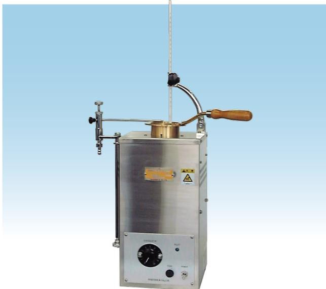
本器は JIS K2265-4、ASTM D92/ISO 2592 の規格に準拠した電気加熱式（電圧調節器付）の引火点試験器です。石油アスファルト、各種潤滑油、流動パラフィン、石油ワックス、切削油剤、熱処理油、エアフィルター油、さび止め油など引火点が 80℃以上の測定に用いられます。試料をヒーターの電圧調節により規定温度勾配で加熱し、規定温度上昇毎に試験炎をカップ上に旋回させ、気化した蒸気に引火したときの温度を読み取ります。
