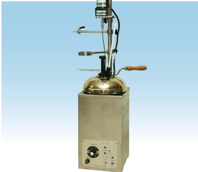
本器は JIS K2265-3、ASTM D93/ISO 2719 の規格に準拠した電気加熱式（電圧調節器付）、電動攪拌機付の引火点試験器です。原油、軽油、重油、航空タービン燃料油、切削油剤、さび止め油など引火点が 50～300℃の測定に用いられます。試料を密閉したカップの中でかき混ぜながらヒーターの電圧調節により規定温度勾配で加熱し、規定温度上昇毎にかき混ぜを止めて試験炎をカップ内にのぞかせ、気化した試料蒸気に引火したときの温度を読み取ります。
